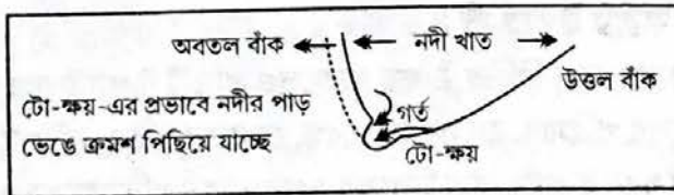
চিত্র : নদীখাতের তলদেশে টো-ক্ষয় ও নদীপাড়ে ভাঙন
